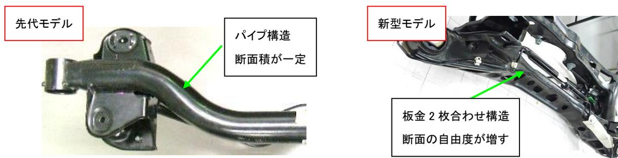
SIDE メンバーは先代が Fr メンバーに接合で、Up アーム、トーコンリンク BRKKT がそれぞれ接合されていたが、新型は SIDE メンバーをリンク BRKKT に結合。リンク BRKKT は Up アーム、トーコンリンクを一体形状にし、一部 Fr メンバーも兼ねる構造に変更しており、無駄に部品点数を増やさないう配慮されている。
