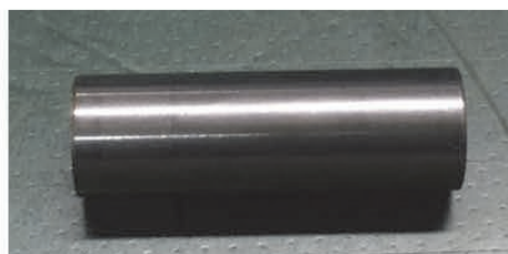
金属カラー(外径13mm,内径10.1mm,全長40.3mm) 表面粗さRa0.5
