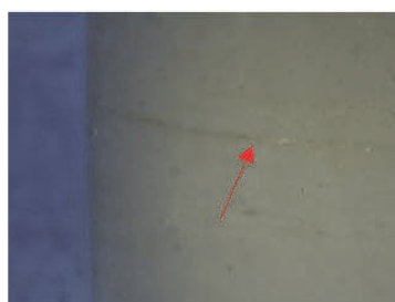
金属カラー(外径13mm,内径10.1mm,全長40.3mm) 表面粗さRa0.5
