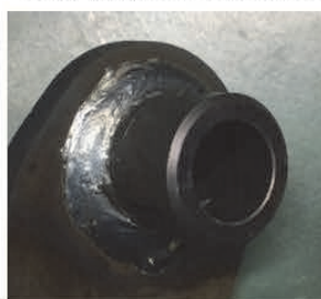
ボス部(外径23mm,内径15mm,全長37.6mm)
