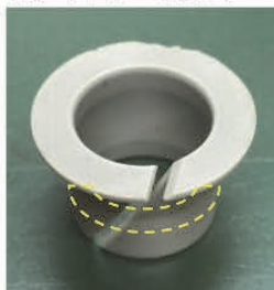
ボス部(外径23mm,内径15mm,全長37.6mm)
