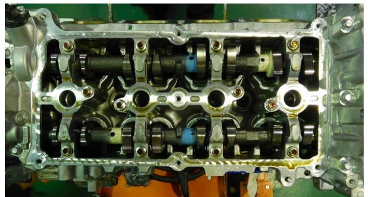
Fig2.1.1 動弁系全体図
