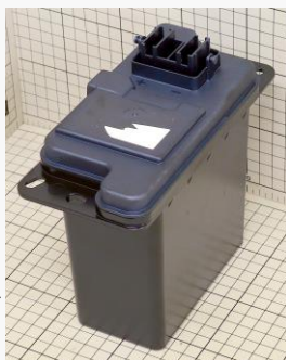
補機バッテリー外観
