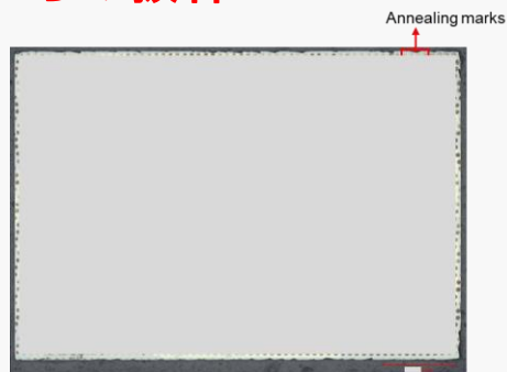
SiC MOSFETチップ裏面 (SiC基板レイヤ)
