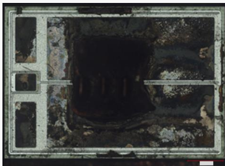
SiC MOSFETチップ (Top Metal レイヤ)
