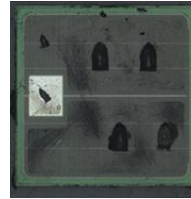
Inventchip Gen3 SiC MOSFET die
