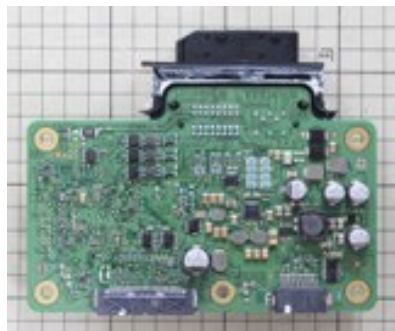
搭載インバータ制御基板
