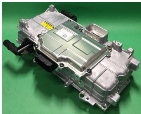
搭載フロントインバーター外観
