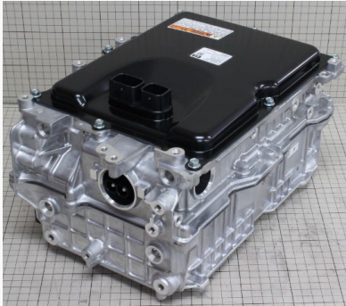
PCU外観写真
