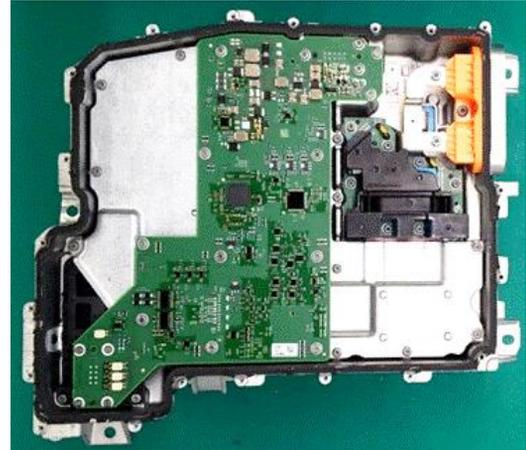
搭載インバーター制御基板
