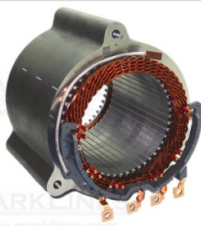
4個の端子があるリアモーター (出所: Munro & Associates, Inc.)
